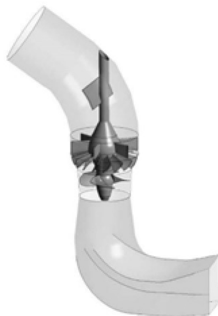
図2. ランナー・ガイドベーン構造概要
